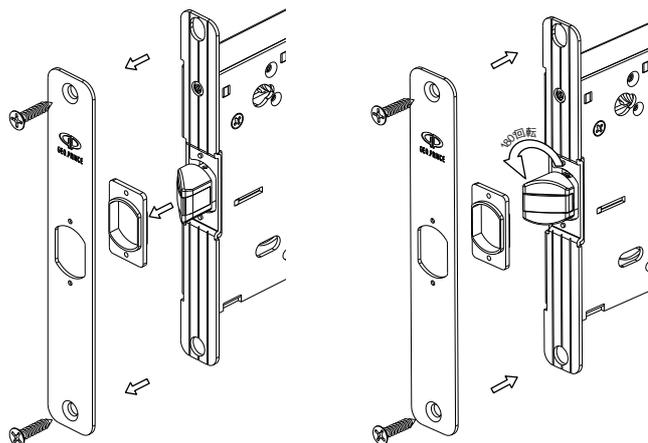
本製品は、右勝手及び左勝手の兼用タイプになっております。左右勝手を変更される場合は、フロントプレート、ラッチ回転止めを取り、ラッチを180°回転させていただき、ラッチ回転止め、フロントプレートを取付けていただくようお願い致します。
