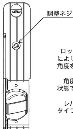
ロックケースフロントの調整ネジを回すことにより、取付けられたレバーハンドルのレバー角度を調整することができます。
