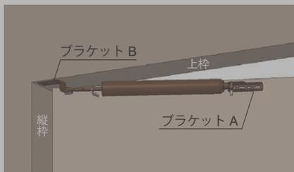
【扉を押す側に取り付け (縦枠) : 最大開扉角度 90°】
