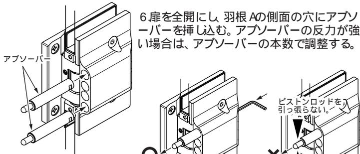
6 扉を全開にし、羽根 A の側面の穴にアブソーバーを押し込む。アブソーバーの反力が強い場合は、アブソーバーの本数で調整する。
