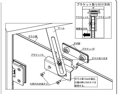
2.ブラケットAがガラス扉の開く方向に向いていることを確認し、ガラス 扉の切り欠きに反対側からブラケットBのダボ部を入れ、ブラケットAを 六角穴付き皿ネジでガラス扉に固定する。
