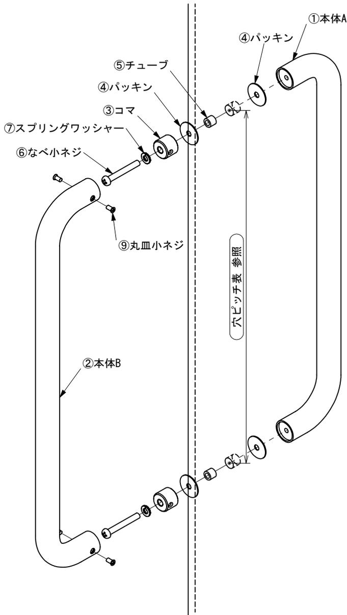
1. 扉に穴（ガラス扉：φ12mm、※木製／鋼製扉：φ7mm）を穴ピッチ表を参照し、2ヶ所に開ける。
