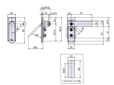
【左右勝手の変更】回転止金具を 90°回転させて取り付けて下さい。
