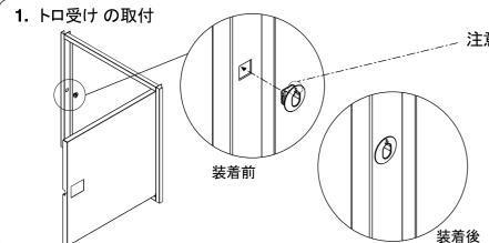
付属のトロ受けを枠側に装着する場合は、 トロ受け表面の "上"刻印を
